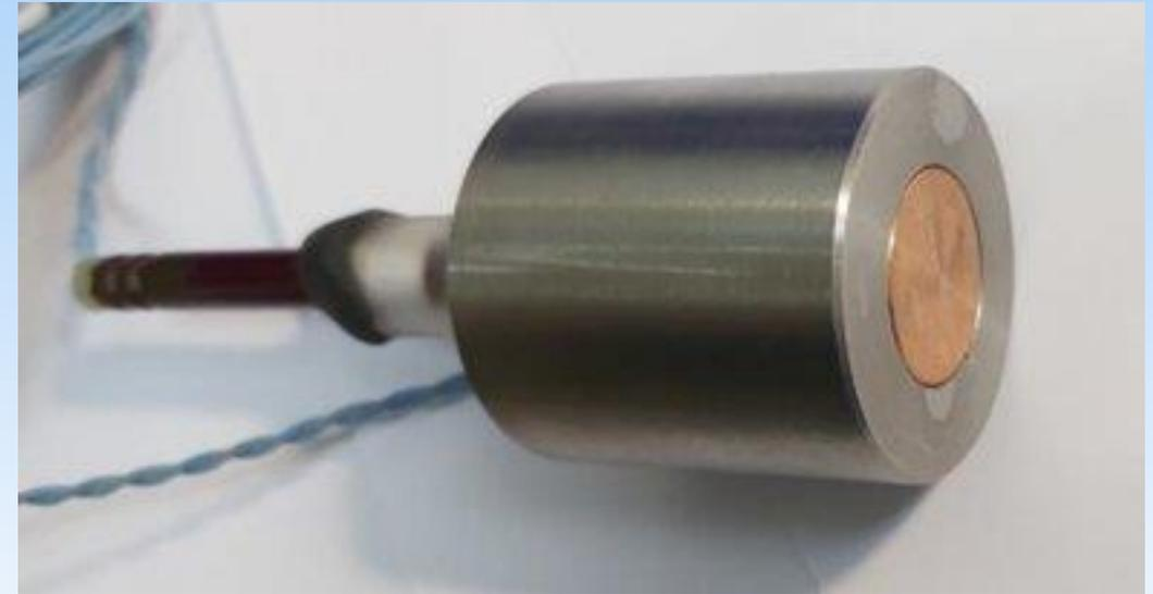
Параметры ударника (медь) – диаметр 20 мм,
