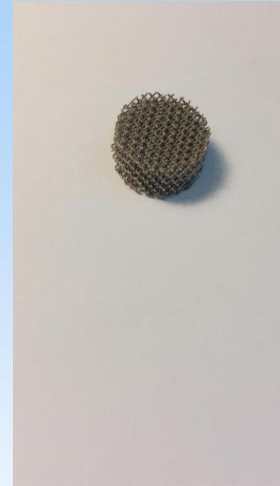
Гироид представляет собой непрерывную (без самопересечений) бесконечно повторяющуюся в трёх измерениях структуру, обладающую средней нулевой кривизной, как и мыльная плёнка.
